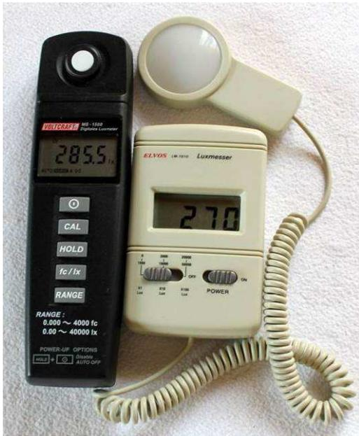
Zwei Luxmeter, einmal mit integriertem Messkopf und mit separatem Messkopf
