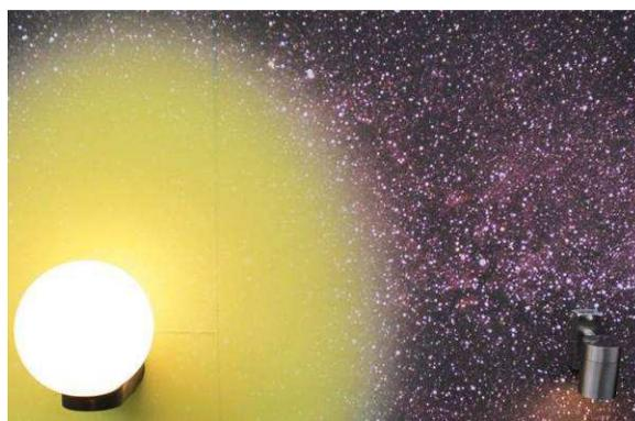
*oben: Die Kugelleuchte links gibt das meiste Licht sinnlos nach oben ab, während die abgeschirmte Leuchte rechts das Licht gezielt nach unten sendet und weniger Licht und damit Strom verbraucht.*
