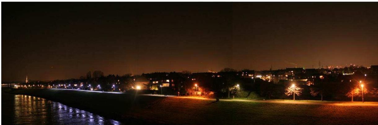
*Fußwegbeleuchtung mit Lichtquellen unterschiedlicher Farben in Düsseldorf (ganz links Gasleuchten, blau: kaltweiße LED, warmweiße LED, gelb: Natriumhochdruckdampf Lampe, grün: Quecksilberdampf Lampe; hellgelb: Halogenmetalldampf Lampe)*
