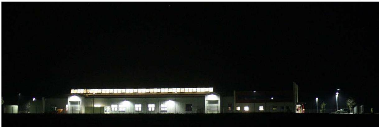
*Die Außenbeleuchtung dieser Fabrikhalle ist voll abgeschirmt, während viel Licht über das Lichtdach ins Freie gestrahlt und dadurch der Sternhimmel verschleiert wird.*
