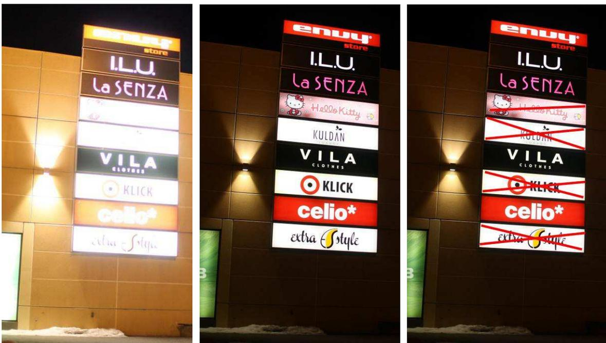
Schriften auf hellem Untergrund (im rechten Bild durchgestrichen) sollten vermieden werden, da sie leicht überstrahlt werden (linkes Bild 16mal empfindlicher).
