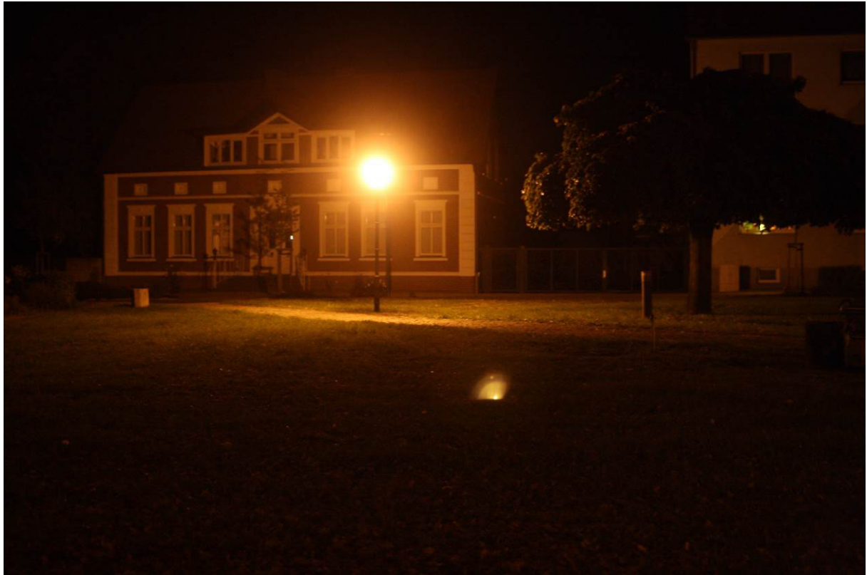
Abb. A16: Rhinow, Marktplatz: rundum leuchtende Laterne wirkt blendend und strahlt stark nach oben.
