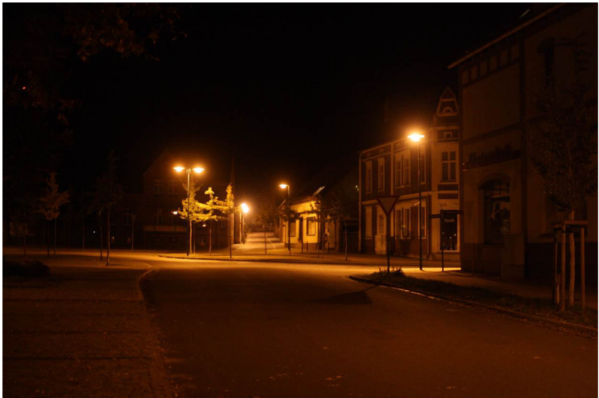
Abb. A17: Rhinow, Marktplatz: Glockenleuchten, die relativwenig Licht nach oben strahlen
