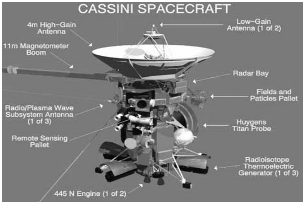
Abb. 9: Die Cassini-Sonde mit der Huygens-Sonde; die Grafik stellt einige wissenschaftliche Instrumente dar {3}
